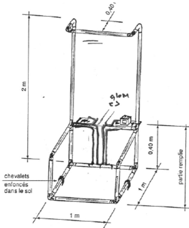
**Poste de tir en tubes P.V.C. de couleur,  $\varnothing$  50 mm
